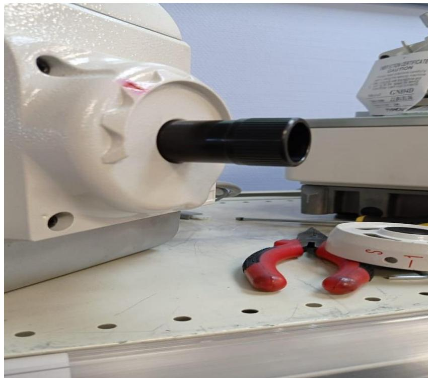
Данная втулка – вспомогательное приспособление для центровки статора мотора. При ремонте, демонтаже и дальнейшей сборке встроенного мотора, статор может неровно установиться.
