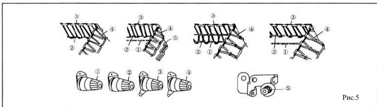
Натяжение нити регулируют в зависимости от типа ткани, ее плотности, используемой нити, ширины шва, длины стежка и т.д. Поэтому, гайки натяжения и нитенаправители специально регулируют в каждом конкретном случае.
